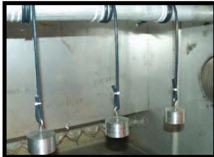
Então, foram parcialmente enrolados em torno de um mandril e sujeitos à tensão fornecida pelo uso de um peso de alumínio.
