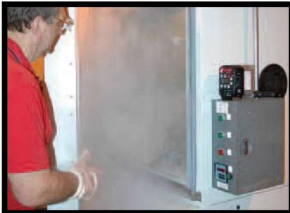
No teste de flexão a frio, os cabos foram primeiramente colocados numa caixa refrigerada.
