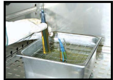
O teste de banho de óleo, realizado conforme especificado na norma UL 1277.
