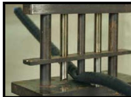
Um mandril com ponta em cinzel numa máquina Instron realiza o procedimento de corte.
